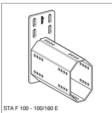
Configuração: Placa base soldada no adaptador octogonal F 100/160
